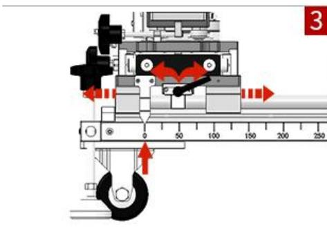
Posición de ajuste de precisión delantera y trasera
