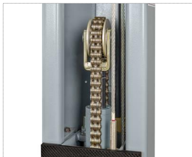
Asiento, bulón y cadena de empuje de grandes dimensiones y
